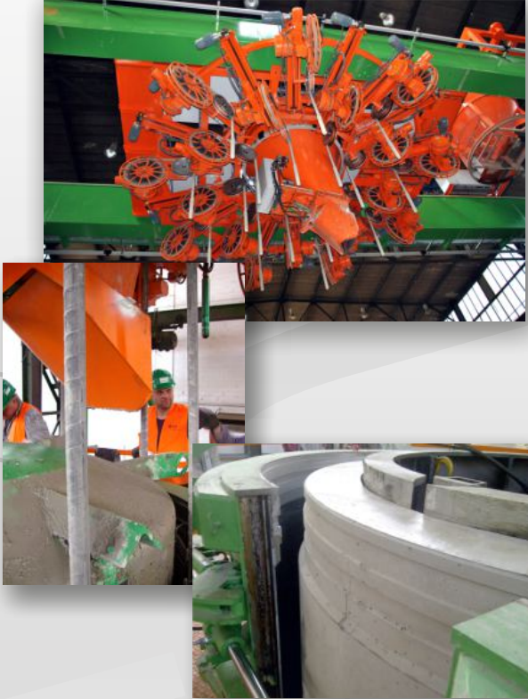
Jacking pipes ø 1.600 - 2.800 x 4.000 mm
